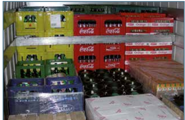
Fig. 13. Bloqueo mediante panel delantero y las puertas especialmente diseñadas para ello.
