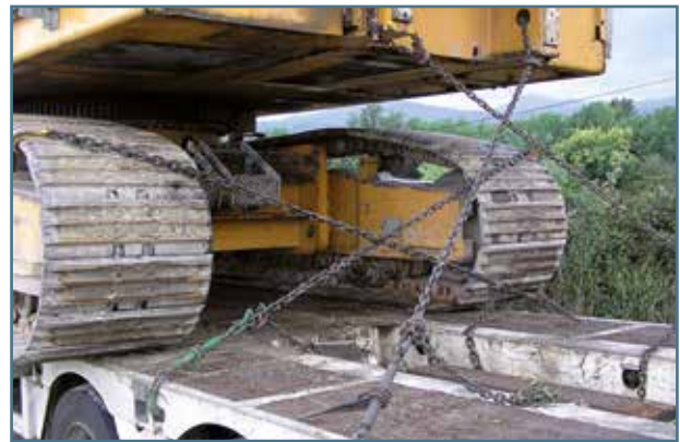
Fig. 39. Excavadora con una fijación oblicua por cadenas.
