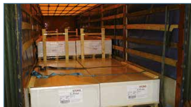
Fig. 19. Bloqueo por paneles de hojas de papel sobre palés.
