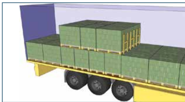
Fig. 18. Bloqueo por paneles hacia adelante en segundo piso.
