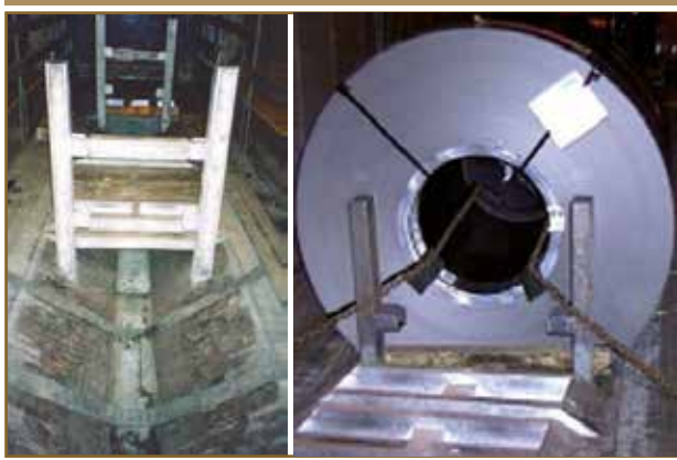
Fig. 81. Fig. 82. Ejemplo de un travesaño que bloquea bobinas.
