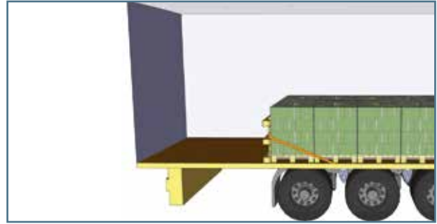
Fig. 28. Sujeción anti-rebote que impide que la mercancía vuelque o se deslice hacia atrás.
