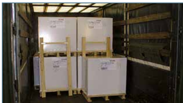
Fig. 18. Bloqueo por paneles hacia adelante en segundo piso.
