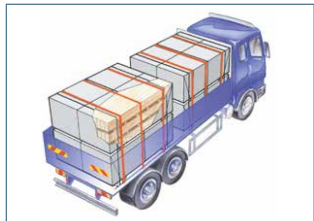
Fig. 51. Carga completa de tablones fijada.
